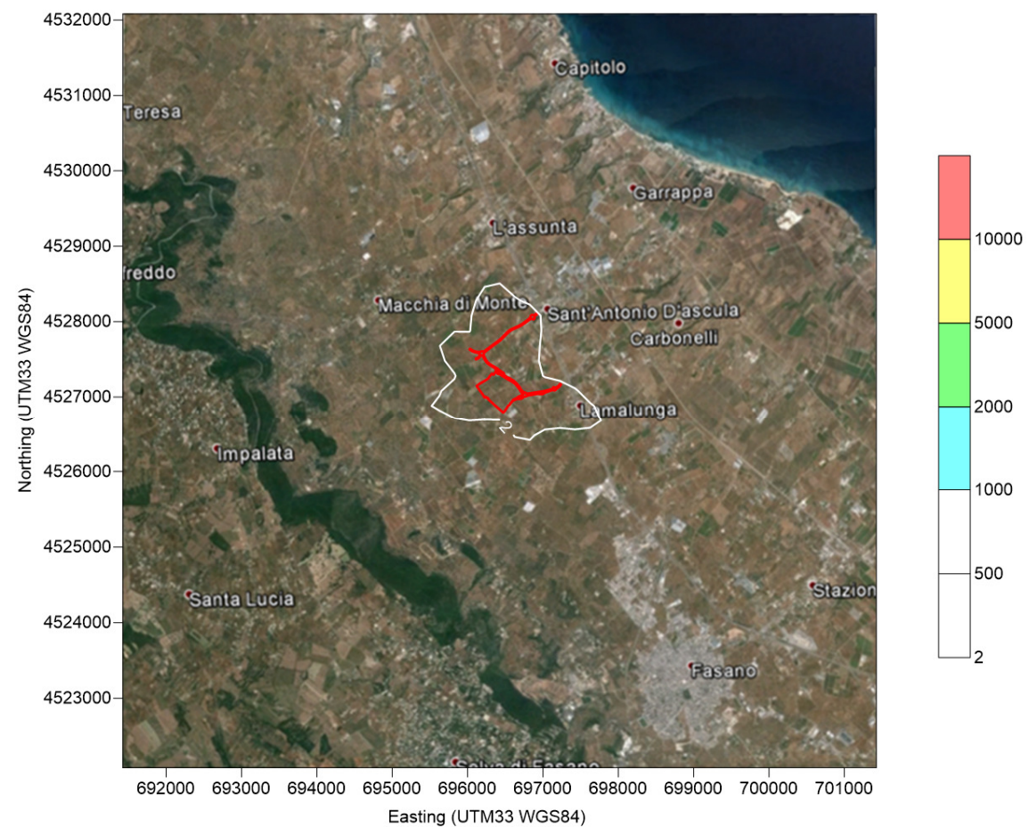
Figura 1- Fase di cantiere, concentrazione media annuale di CO [ \mu\text{g}/\text{m}^3 ].
